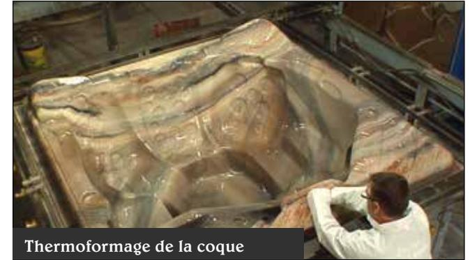
Thermoformage de la coque
